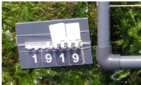
Abb. 6: Nummernblock zur einfachen Darstellung der Stationsnummer bei der fotografischen Dokumentation
